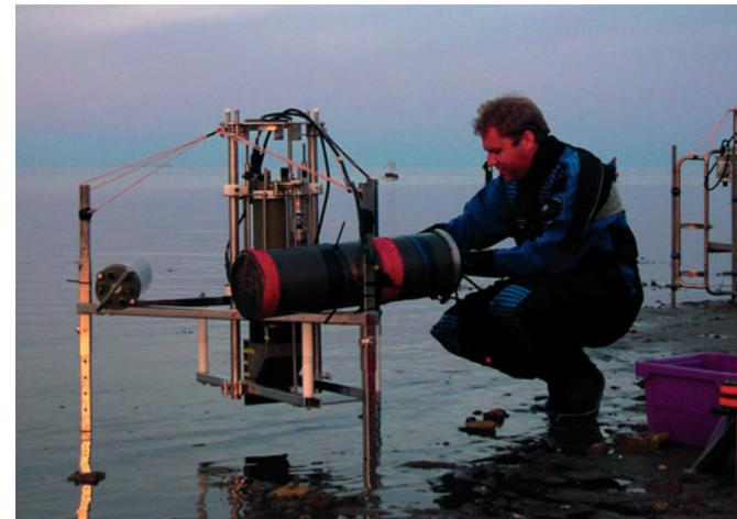
Mit empfindlichen Mikrosensoren, die unterhalb des Metallzylinders angebracht sind, misst der Mikroprofiler vertikale Konzentrationsprofile im Sediment. Ein computergesteuerter Schrittmotor senkt die Sensoren in 1-mm-Schritten automatisch in den Sand.
