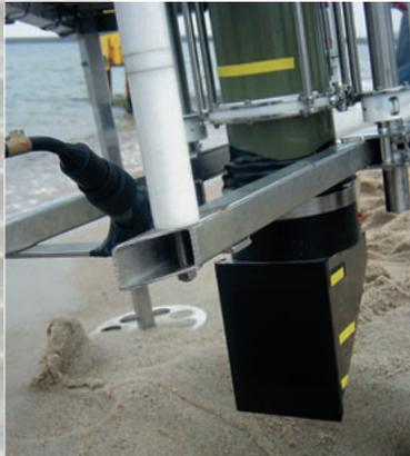
Um die Sauerstoffkonzentration im Querschnitt des Sediments messen zu können, registriert die CCD-Kamera des Optoden-Roboters die Fluoreszenz-Signale einer sauerstoffempfindlichen Sensorfolie, die senkrecht in den Sand gefahren wird.
